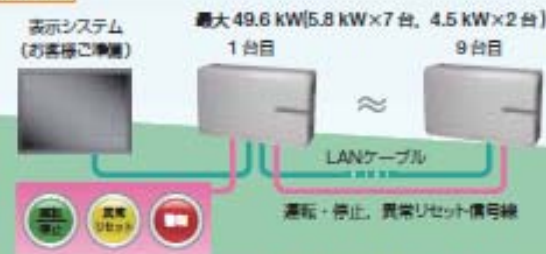
(注) 1 運転・停止、異常リセット用の有線・無線はお客様でご準備ください。2 リモコン、LANケーブルはオプション
